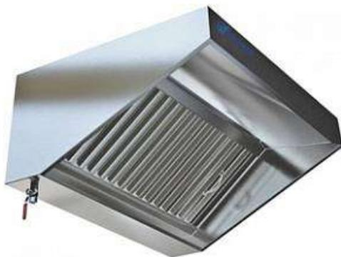
**ЗОНТ ВЫТЯЖНОЙ ПРИСТЕННЫЙ НКН KWE-211/1310** для очищения воздуха от излишков дыма, пара, жира и продуктов горения. Каркас и рабочая поверхность выполнены из нержавеющей стали AISI 430. В комплект входит: лабиринтные фильтры-жироуловители и сливные краны. Модель имеет габариты: 1300x1000x400 мм. Вес зонта составляет 36,4 кг.
