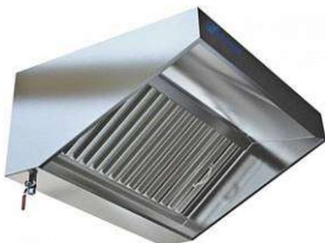
**ЗОНТ ВЫТЯЖНОЙ ПРИСТЕННЫЙ НКН KWE-211/1010** для очищения воздуха от излишков дыма, пара, жира и продуктов горения. Каркас и рабочая поверхность выполнены из нержавеющей стали AISI 430. В комплект входит: лабиринтные фильтры-жироуловители и сливные краны. Модель имеет габариты: 1000x1000x400, мм. Вес зонта составляет 29,4 кг. 0,4 V, мЗ.
