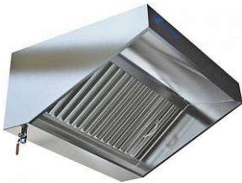
**ЗОНТ ВЫТЯЖНОЙ ПРИСТЕННЫЙ НКН KWE-211/1510** для очищения воздуха от излишков дыма, пара, жира и продуктов горения. Каркас и рабочая поверхность выполнены из нержавеющей стали AISI 430. В комплект входит: лабиринтные фильтры-жироуловители и сливные краны. Модель имеет габариты: 1500x1000x400 мм. Вес зонта составляет 40,3 кг. 0,58 V, мЗ.
